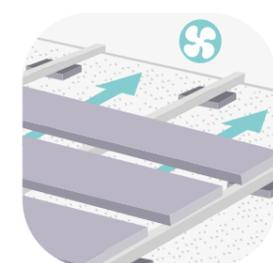
Prévoir une ventilation complète entre le sol et les lames de terrasse (ainsi qu'au niveau de la périphérie de l'ouvrage, passage d'une lame d'air obligatoire).
